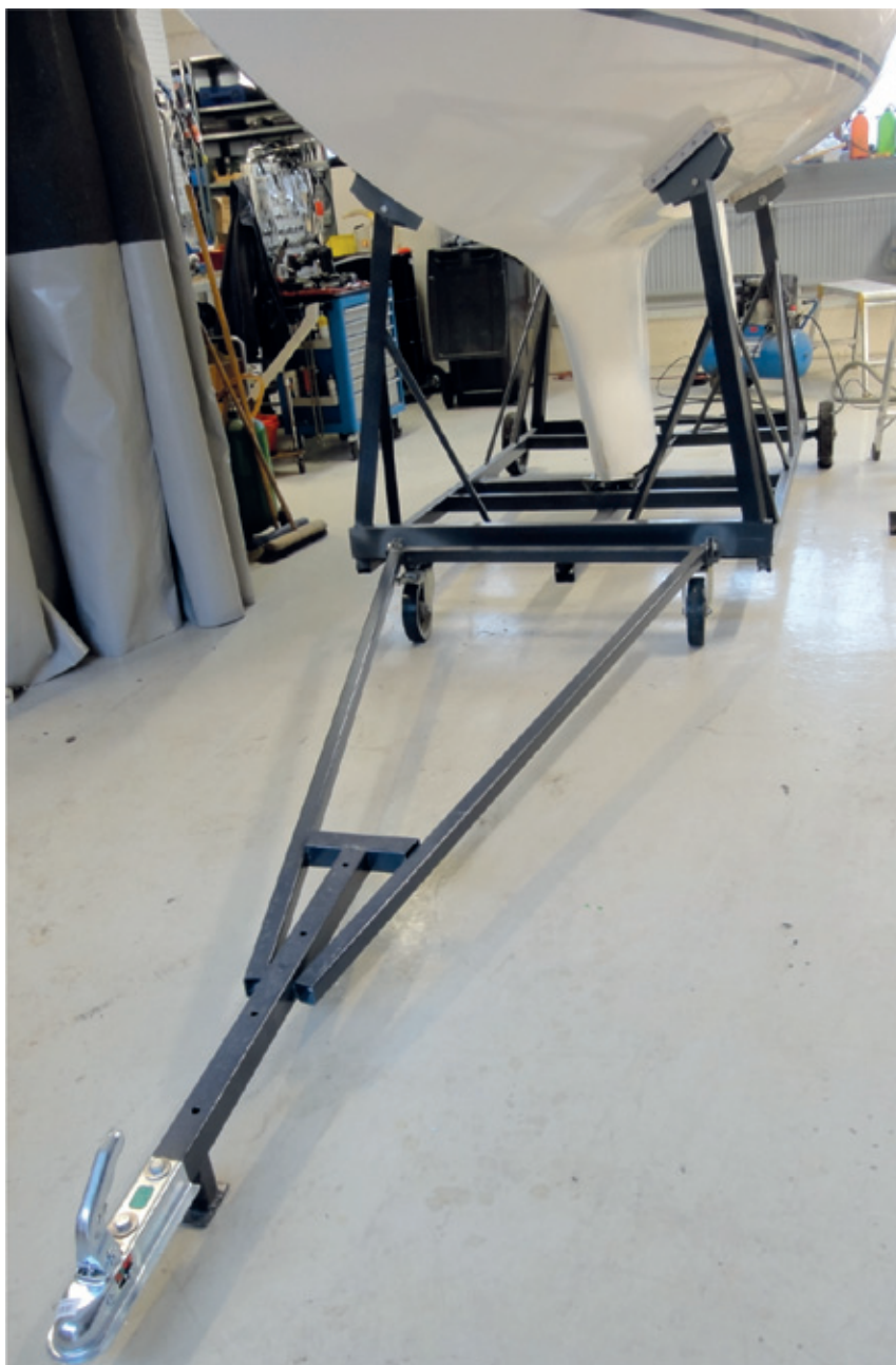
Puunattu tukki. Vanhan pukan alle lisäpalkit. Taakse kiinteät isommat pyörät. Eteen 200 mm kääntyvät pyörät ja irroitettava vetoaisa. Ei maantielle.
